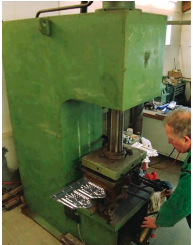
11 Die Bleche werden mit einer hydraulischen Presse geformt
