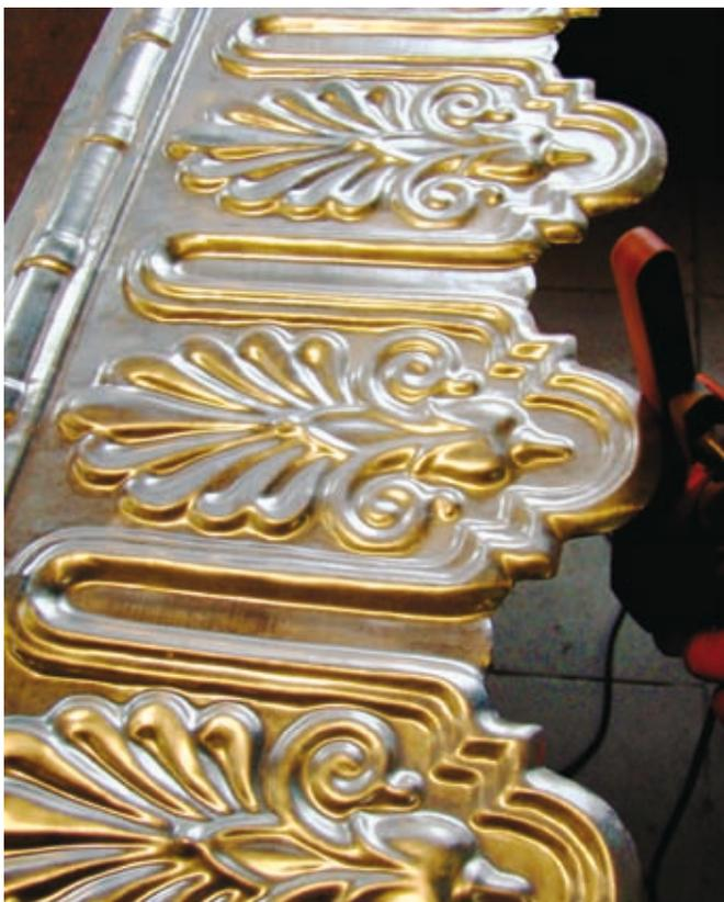
12 Die gepressten Bleche werden ausgesägt und gefeilt.
