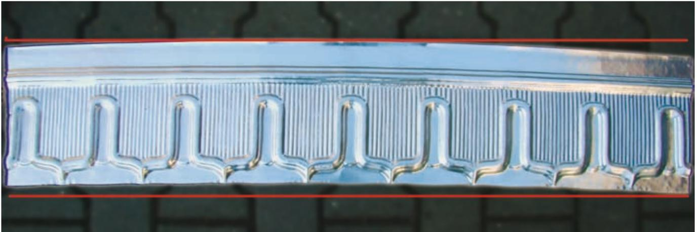
13 Gepresstes Blech, das sich verzogen hat; sichtbar an der oberen und unteren Kante.
